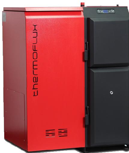
**PELLING** vastab standardi EN 303-5-2012 kõrgeima **klass 5** nõuetele, millega on tagatud katla kõrge kasutegur ja ohutu töö. **PELLING** -us sobivad põletamiseks Ø 6 mm läbimõõduga, 6-30mm pikkusega ja kuni 12% niiskusesisaldusega puidupelletid.
